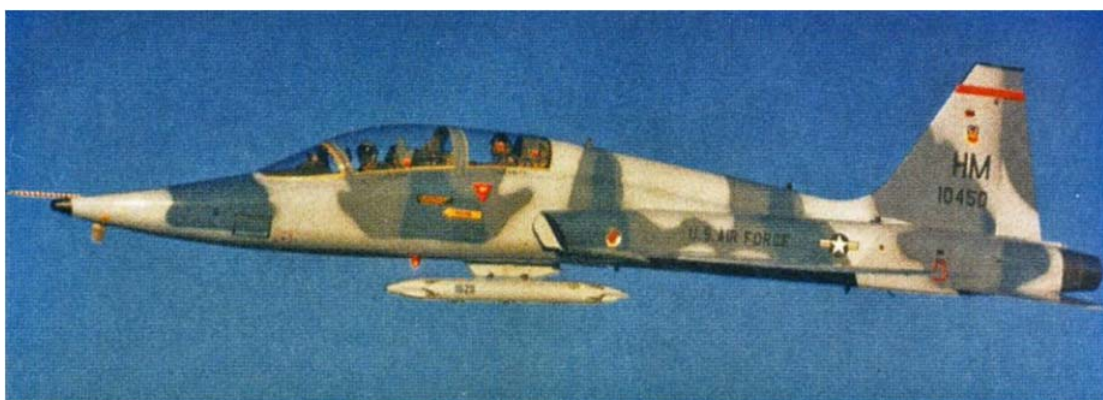
图 1.8 挂有训练弹发射巢的迷彩 T-38V
