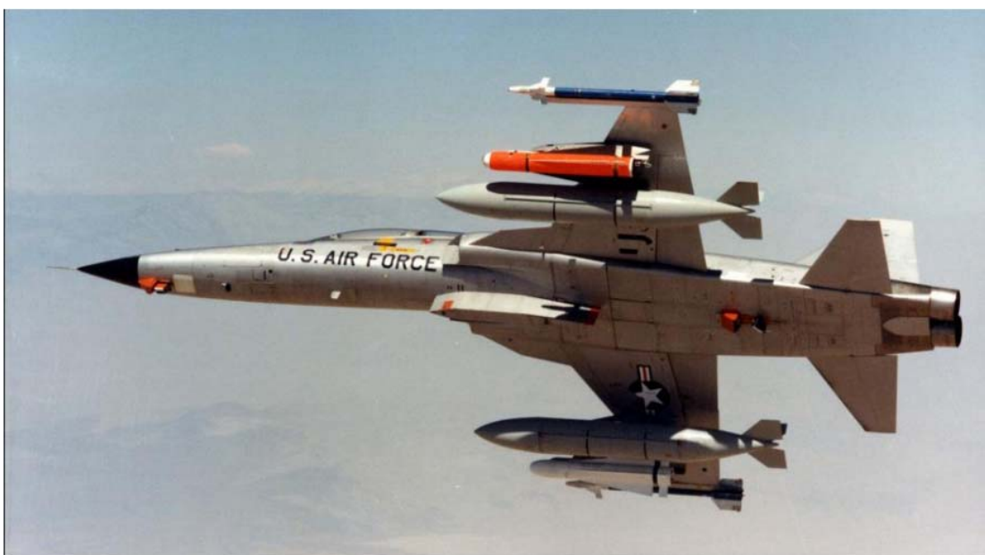
图 1.27 携带副油箱、小牛导弹、响尾蛇导弹的 F-5F，机鼻下的红色盒子是武器使用记录相机
