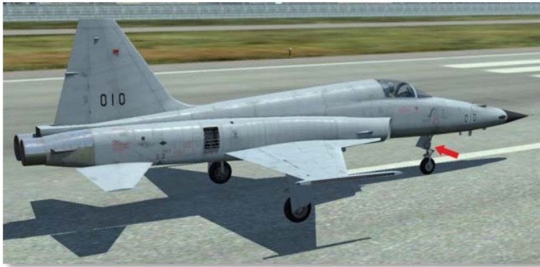
前起落架支柱收缩 ( normal 位置)
