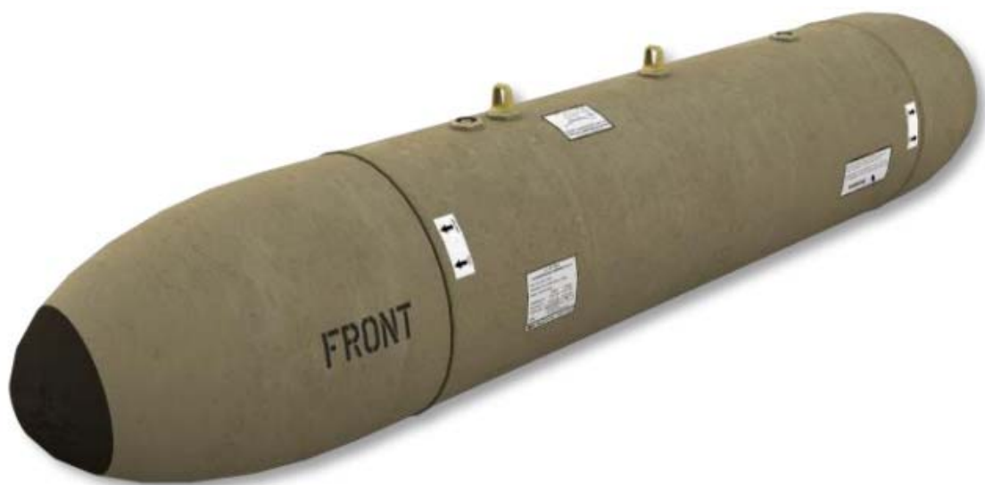
LAU-3 可以装填 19 枚 2.75 英寸火箭弹。
