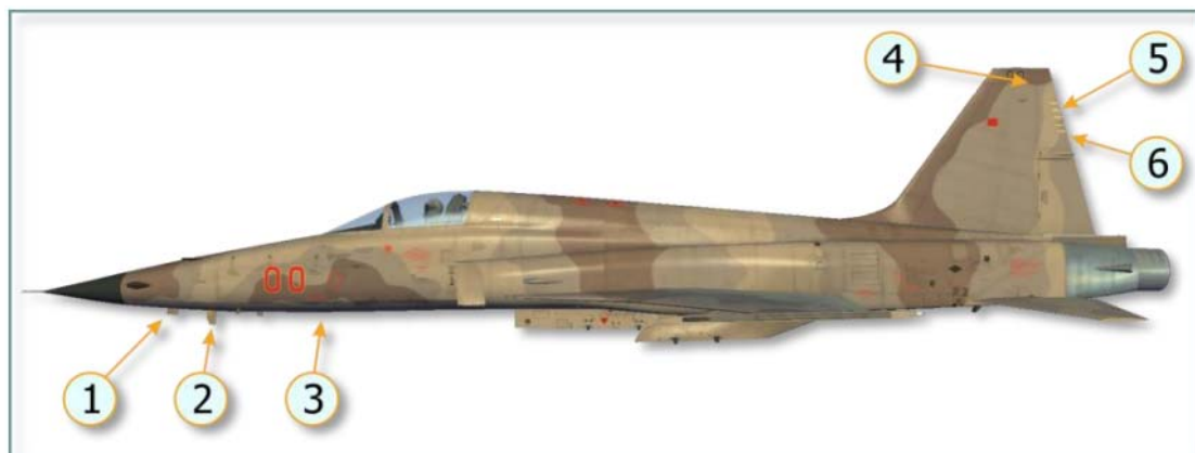
图 6.17 飞机天线布置
