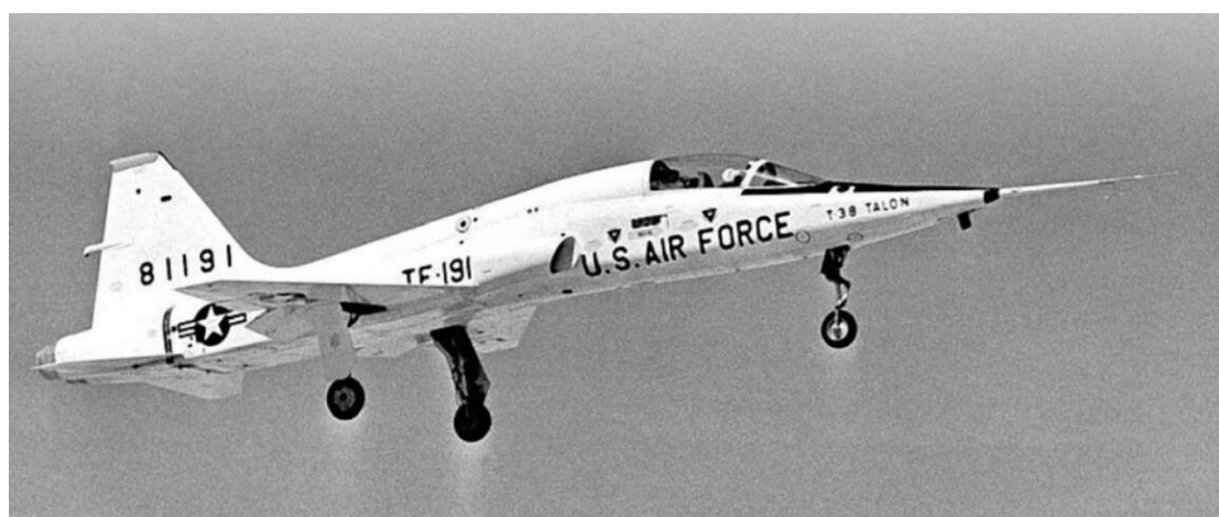
图 1.5 最初的 3 架 YT-38 试飞时总是使用封闭的后舱来携带不同的测试设备
