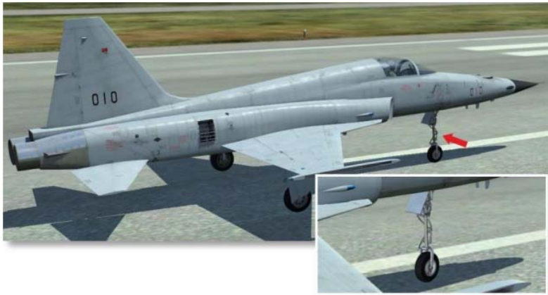
前起落架支柱伸长 ( lengthened 位置)
