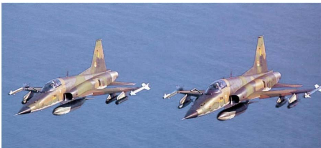
图 1.28 巴西空军 2 架安装有空中加油管的 F-5E
