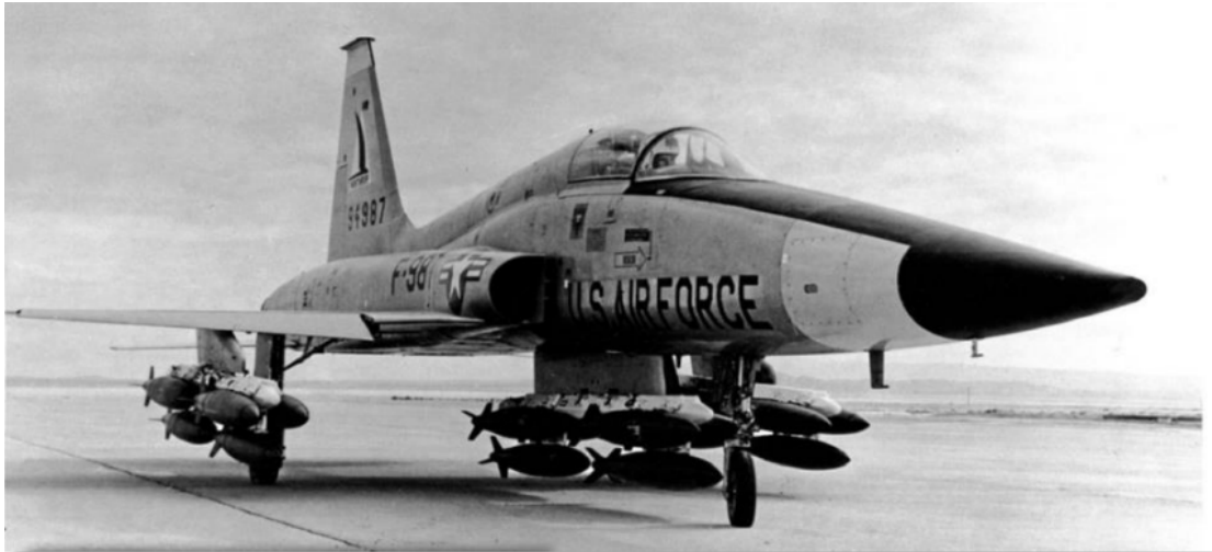
图 1.13 N-156F 原型机通过 3 个挂架携带 250 磅炸弹
