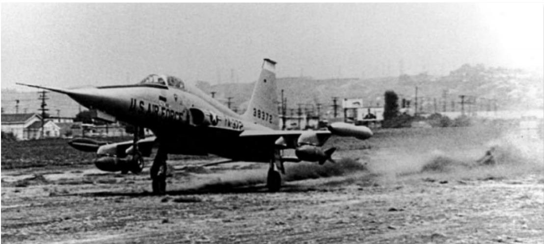
图 1.12 诺斯罗普 YF-5A（S/N63-8372）携带 2 枚 500 磅炸弹和翼尖邮箱在未铺装场地降落（美国空军图片）
